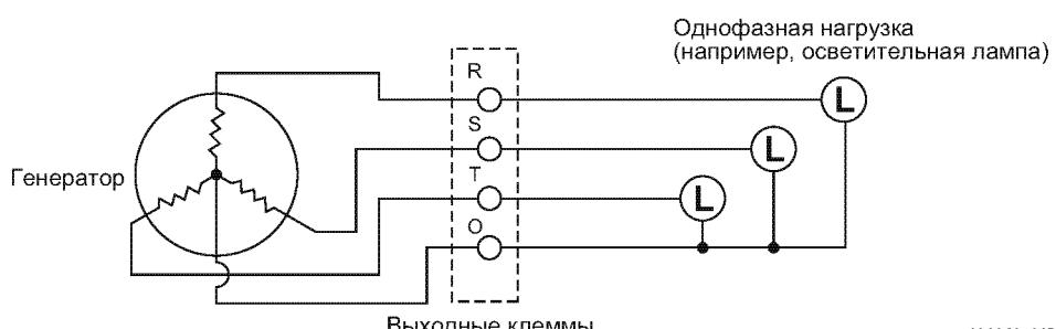
Нагружайте выход генератора так, чтобы каждая фаза была сбалансирована. Если нагрузка не сбалансирована, выдерживайте разность фаз в пределах 20%.
