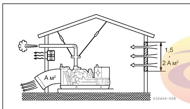
3. Необходимо обеспечить выход выхлопного газа через вытяжную трубу и т.п. Если необходимо, обеспечьте защиту от попадания осадков. Выхлопная труба должна быть подвешена по следующим причинам:
